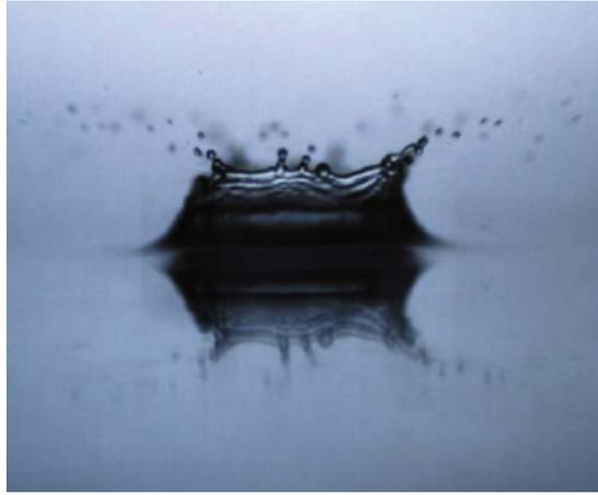
Рисунок 1.22: Пример расплескивания жидкости при столкновении капли с толстым слоем жидкости. Иллюстрация взята из [72]. Параметры эксперимента: вода,  $D = 2$  мм,  $\delta = 70$ ,  $u = 338.0$  см/с.
